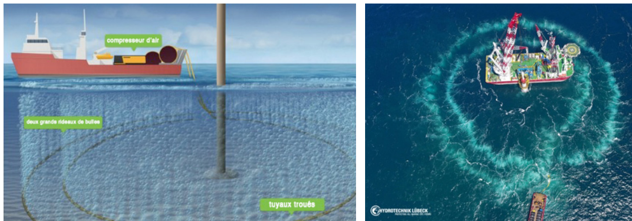
Figure 1 : Un rideau de bulles aide à réduire le bruit du battage de pieux. © gauche : Dantysk, droite : Hydrotechnik Lübeck
